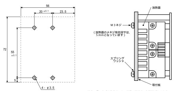
注意:長いネジを使用すると、部品に接触する危険性があります。 ネジの長さは取付板の厚み + 5 mm以下のサイズを使用して ください。
