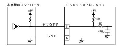
ホールドオフ入力信号が"L"レベルの時、モーターには電流が流れなくなり(保持力が解除されます)、モーターシャフトを外力でまわすことができます。
