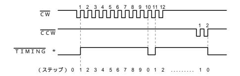
\*接続例の通りに使用しますと、ステップ「0」の時、"L"レベルとなります。
