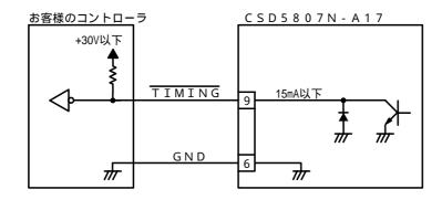
励磁タイミング出力信号はモーターの励磁状態が初期の設定状態(ステップ 0 )にあることを示す信号です。装置側の機械原点とモーターの励磁原点(ステップ 0 )を一致させ、より正確な原点検出を行うときなどに使用します。(オープンコレクタ出力)
