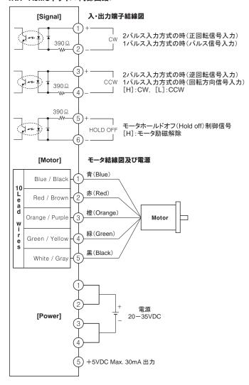
注)入力信号電圧が+5VDCより大きい場合は、外部に電流制限抵抗を取り付けてご使用
