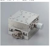
■移動ガイドにクロスローラ・送り機構にウォームギヤを採用した高精度ゴニオステージです。 回転中心振れ精度は0.01mm以下(1軸)と高精度です。 操作感が非常によく、頻繁に繰返し駆動させる用途に最適です。
