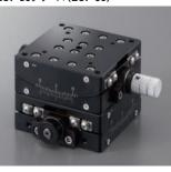
■移動ガイドにクロスローラ・送り機構にウォームギヤを採用した高精度ゴニオステージです。 回転中心振れ精度は0.01mm以下(1軸)と高精度です。 操作感が非常によく、頻繁に繰返し駆動させる用途に最適です。
