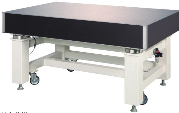
全方位対応三次元空気ばねを使用したフラッグシップモデル。
