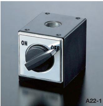
M16P=1の取付けねじを持つロッドスタンド等を取付けることが可能です。また、アダプタプレート▶P.3-144を使用することにより、□40mm、□60mmの各種ステージを取付けることも可能です。
