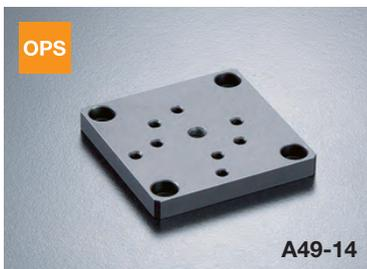
オプトステーション用ミラーホルダ (F531-12.7/20, F534-20B ▶ P.3-012) を45°配置にする場合に使用するアダプタプレートです。下面プレートを付け変えることにより45°配置変更ができます。
