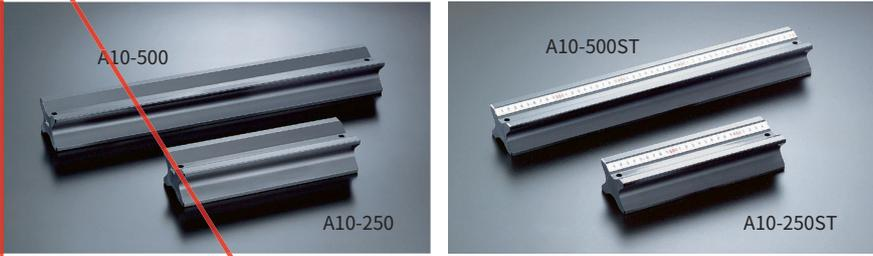
断面が70mm×50mmと安定したX型のアルミ製光学ベンチです。軽量・不錆であり、専用のキャリアにより直線的な光学実験系を構成できます。型式の末尾/STが付いているものはスケール付きの製品です(目盛1mm)。規格外の長さのものについては、お問い合わせください。光学ベンチに積載する総荷重は、偏荷重や集中荷重を避けた上で、ベンチ自重の10倍以下を目安にしてください。
