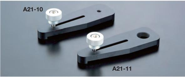
除振台上の任意の位置にロッドスタンドを置くことができるベースプレートです。先端にM6P=1/M16P=1のねじ穴があり、ここにロッドスタンドをねじ込み固定します。除振台には付属しているクランプにて固定します。手でかるく固定し、微妙な位置合わせ後六角レンチで締め固定します。
