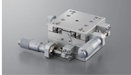
■移動ガイドにクロスローラ・送り機構にマイクロメータを採用した高精度ゴニオステージです。回転中心振れ精度は0.01mm以下(1軸)と高精度です。微細な位置決め用途に最適です。
