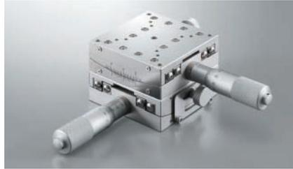
■移動ガイドにクロスローラ・機構にマイクロメータを採用した高精度ゴニオステージです。回転中心振れ精度は0.01mm以下(1軸)と高精度です。微細な位置決め用途に最適です。
