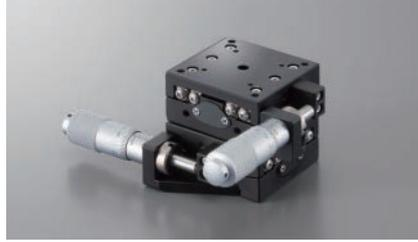
■移動ガイドにクロスローラ・送り機構にマイクロメータを採用した高精度ゴニオステージです。
