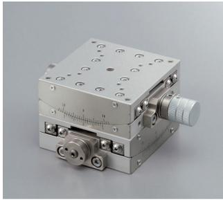
■移動ガイドにクロスローラ・送り機構にウォームギヤを採用した高精度ゴニオステージです。回転中心振れ精度は0.01mm以下(1軸)と高精度です。操作感が非常によく、頻繁に繰り返し駆動させる用途に最適です。
